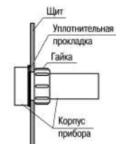
Рисунок 1 – Монтаж прибора щитового крепления
